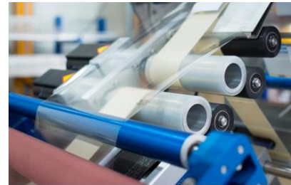
Etiketleme birimi; hem yeni makinelere opsiyonel olarak hem de diğer üreticilerin tesislerini yenilemek ve geliştirmek amacıyla takılabilir şekilde yapıldı.
